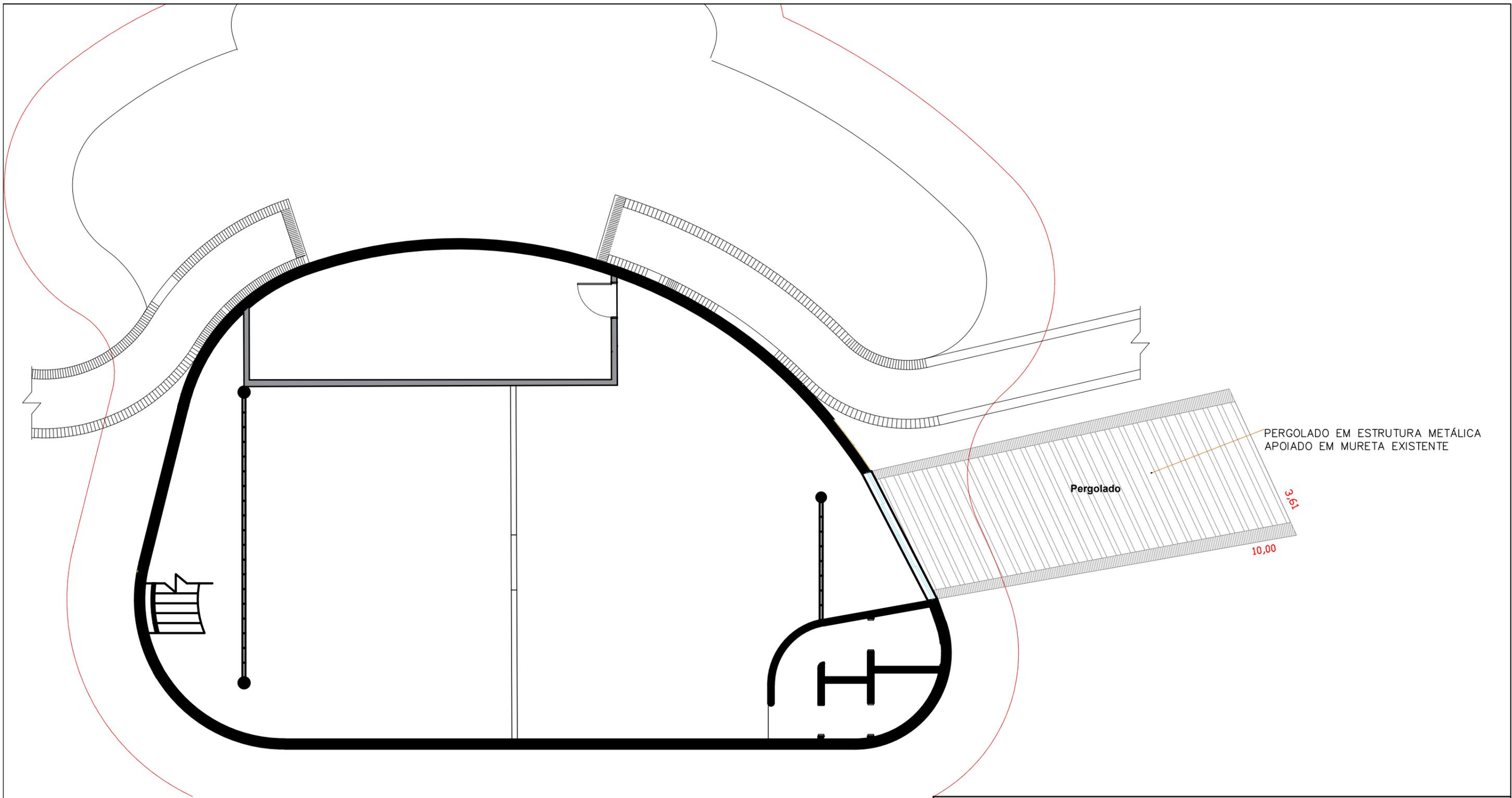
PERGOLADO EM ESTRUTURA METÁLICA APOIADO EM MURETA EXISTENTE
